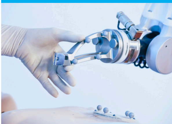
Robot EPIONE®. Diseñado para ablación percutánea. Se puede utilizar con diferentes tecnologías ablativas como radiofrecuencia, microondas, crioablación o electroporación irreversible. https://www.quantumsurgical.com/epione/
