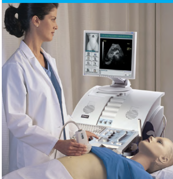
UltraSim. El intervencionista realiza una ecografía al maniquí, al mismo tiempo que se carga un caso clínico en la computadora; esta luego reproduce en el monitor las imágenes esperadas
